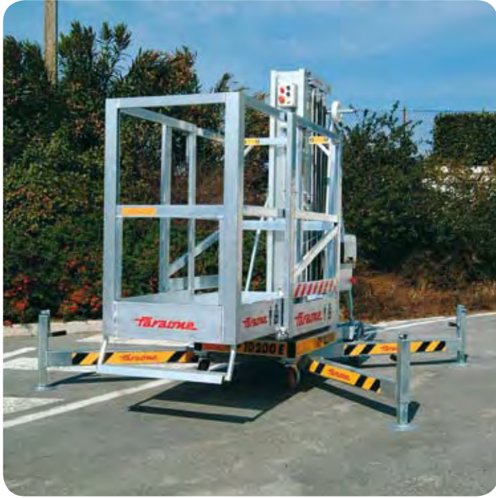
Doppio posizionamento del cestello a cm 30 o 90 da terra per modelli PK8000E e PK10200E, a 30 o 237 cm da terra per modello PK16000.
