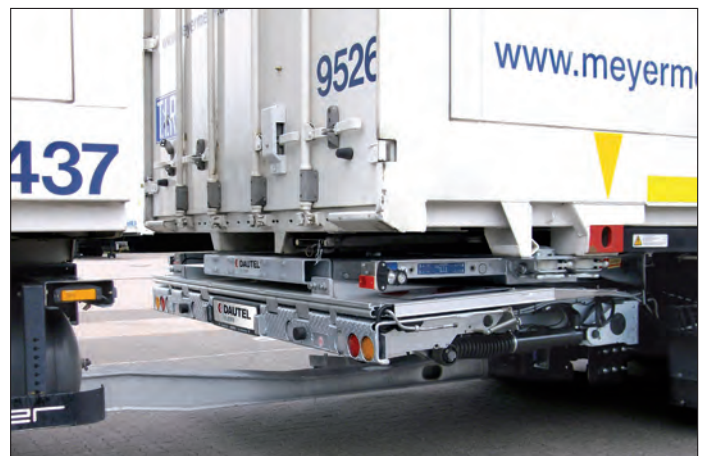
DAUTEL SLIDER DS-VT XXL, Abstellhöhe 970 mm
