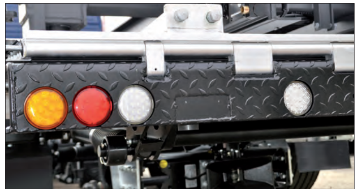
LED-Schlussleuchten, Kennzeichenhalter und Beleuchtung
