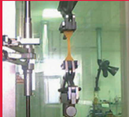
Zugversuch zur Überprüfung der Elastizität und Materialgüte Pulltest to control the elasticity and the material quality
