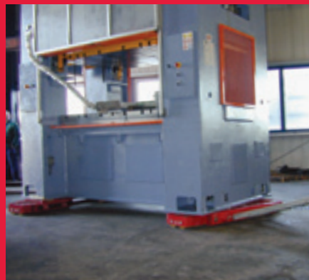
iX48L und iX645 im Einsatz bei einem Pressentransport iX48L and iX645 seen above in use moving heavy machinery
